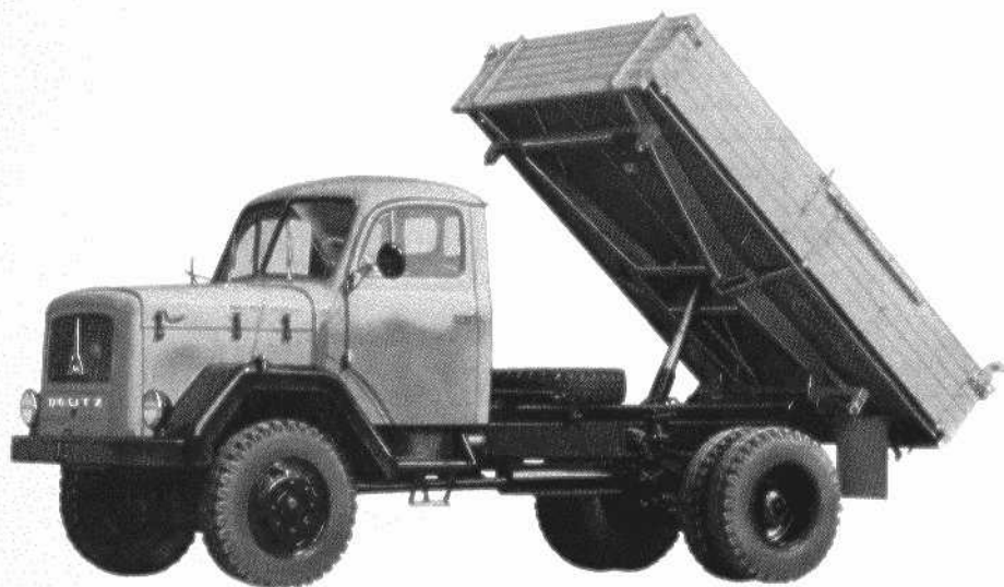
Allrad-Dreiselenklipper MAGIRUS 135 D 12 AK
